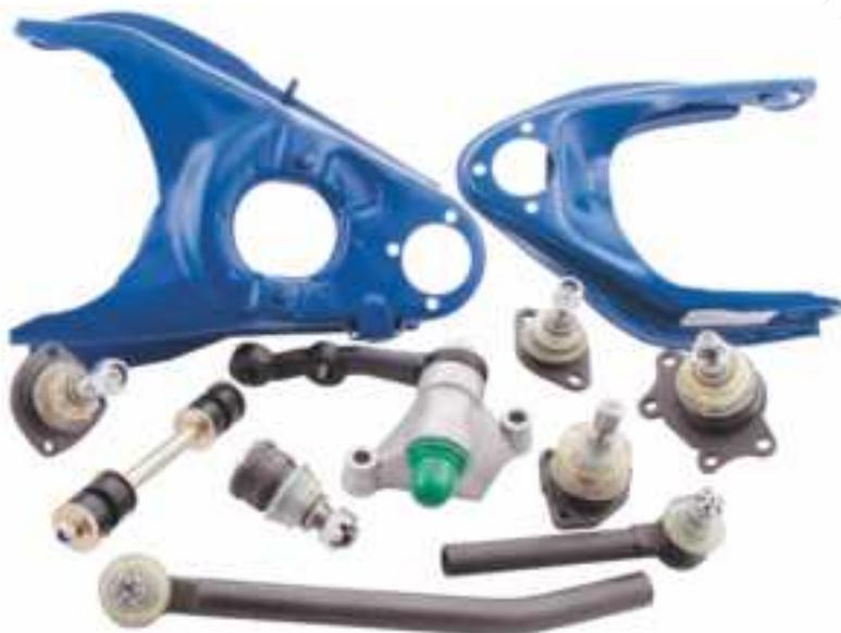
Герметичность изделий обеспечивается использованием защитных чехлов из высоконаполненных полимеров на основе каучука.
